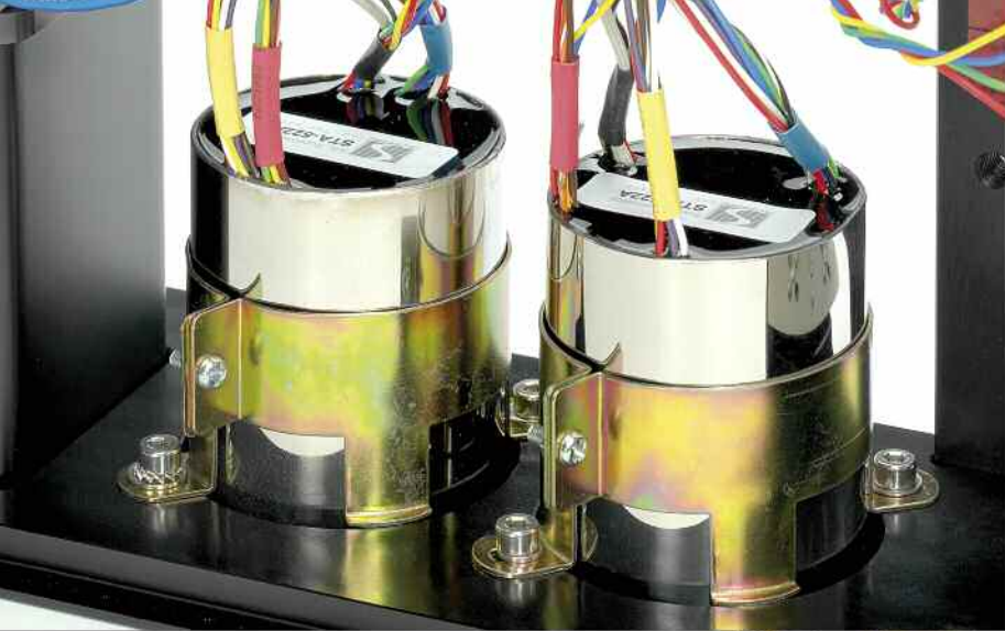
Links: Glänzend: Eingangsübertrager von Silk Audio mit Permalloy-Kern für besten Klang und geringstmögliche HF-Einstreuungen
